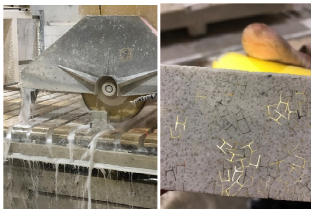
Рисунок 2. Срез пилой с водяной подачей
