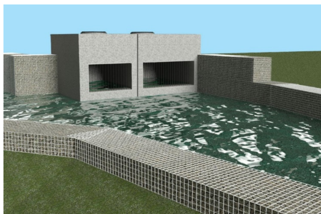
Рис.1. – Общий вид водосброса и габионных конструкций
