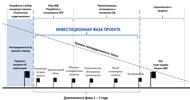
Рис. 1 Основные вехи развития проекта в ходе инвестиционной фазы (Рис. 1-3 в настоящей статье представлены по результатам работы автора).
